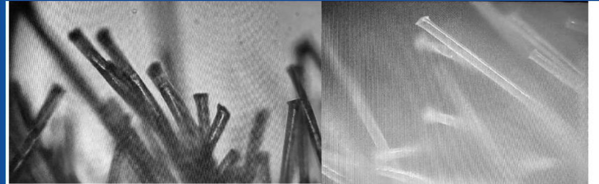
Abbildung 1 und 2 Nylon-Hohlfasern am gebrochenen Ende der Testtupfer.
